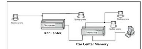
В случае, если здание находится на удаленном расстоянии от диспетчерского центра, для передачи данных с концентратора Izar Center Memory используется Ethernet соединение либо модем, подключенный через интерфейс RS 232. Также можно настроить концентратор на автоматическую выгрузку данных на FTP-сервер.
