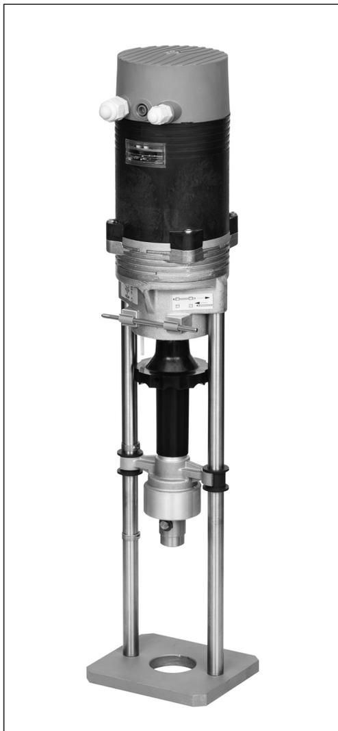
Привод предназначен для управления регулирующими клапанами трехпозиционным или аналоговым сигналом от электронных регуляторов в системах центрального тепло- и холодоснабжения, отопления, вентиляции и кондиционирования воздуха. Используется с клапаном VF 3 (DN 200–300).
