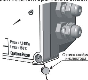
Рис. 4 – Место установки пломбы инспектора
