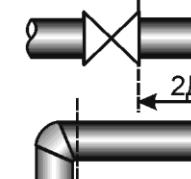
Отвод, колено, полностью открытая задвижка (за исключением шаровой), гильза термопреобразователя
