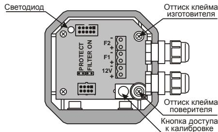
Рис. 3 – Места пломбирования
