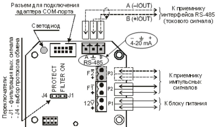
Рис. 2 - Внешний вид платы блока электронного преобразователя
