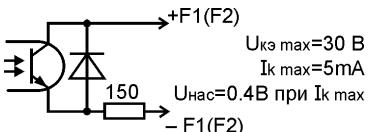
Рис. 3 – Схема выходного каскада
